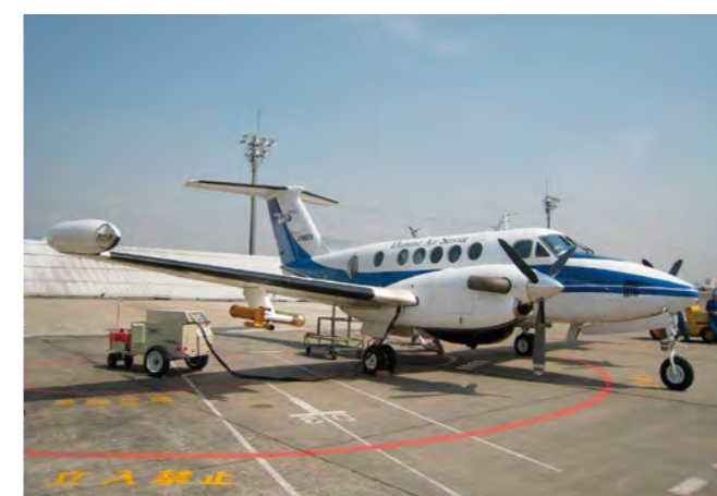
エアロゾル・雲観測で使用している観測航空機。翼の下に取り付けられている金色の装置でエアロゾルや雲を測定する。機内にも観測機器が満載され、機体の屋根に取り付けられた取り込み口から空気を機内に引き込んで計測を実施する。
