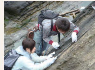
地層の向きや傾きを計測して、それを地図上にプロットして行く。
