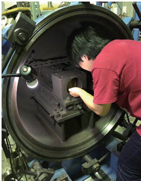
▲火星隕石の衝撃変成模擬実験
