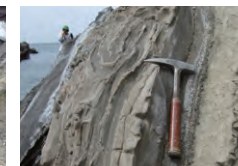
◀▲地層の向きや傾きを計測して、それを地図上にプロットして行く。
