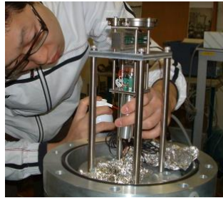
マグマなど地下流体の動きによる重力変化を精密計測するために開発中の小型絶対重力計。
