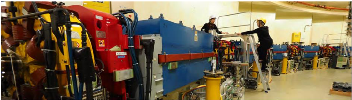
図1 Photon Factoryの光源加速器。周回する25億電子ボルトの電子ビームから発生する放射光は、リング壁を隔てた実験ホールに輸送され、分光器やミラーで加工された後、実験ステーションにおいて各種の測定に利用される。
