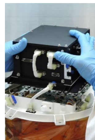
あらせ衛星に搭載した 中間エネルギー電子分析器
