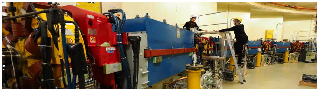
写真1 Photon Factoryの光源加速器。周回する25億電子ボルトの電子ビームから発生する放射光が、リング壁を隔てた実験ホールに輸送され、分光器やミラーで加工された後、実験ステーションにおいて各種測定に利用される。
