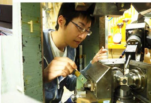
写真3 実験ステーション AR-NE5C で 500ton プレスの加圧準備をする若林大佑助教。NE5Cでは、液体の相転移や微量元素の化学状態の変化の観察を目的として、高温高圧下X線回折・XAFS複合測定のための技術開発が進められている。
