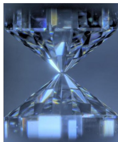
超高压発生用ダイヤモンドアンビル装置。
