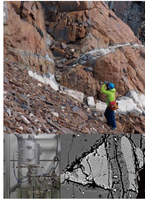
地殻深部の岩石破壊の地質調査(上)と室内実験による再現(下)。
