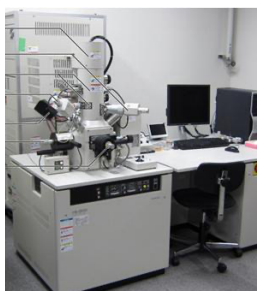
任意の箇所から薄膜 TEM 試料を製作する集束イオンビーム加工装置
