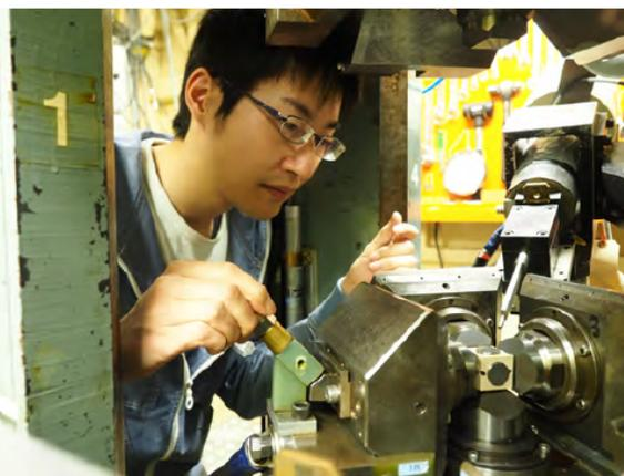
写真3 実験ステーションAR-NE5Cで500tonプレスの加圧準備をする若林大佑助教。NE5Cでは、液体の相転移や微量元素の化学状態の変化の観察を目的として、高温高圧下X線回折・XAFS複合測定のための技術開発が進められている。
