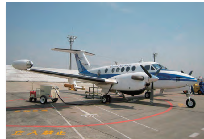
エアロゾル・雲観測で使用している観測航空機。翼の下に取り付けられている金色の装置でエアロゾルや雲を測定する。機内にも観測機器が満載され、機体の屋根に取り付けられた取り込み口から空気を機内に引き込んで計測を実施する。
