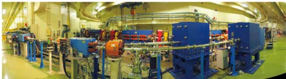
写真1 Photon Factoryの光源加速器。手前の入射路から奥の蓄積リング(右奥で合流)に導入されて周回する25億電子ボルトの電子ビームから発生する放射光が、リング壁を隔て向こう側の実験ホールに輸送され、分光器やミラーで加工された後、実験ステーションにおいて各種測定に利用される。
