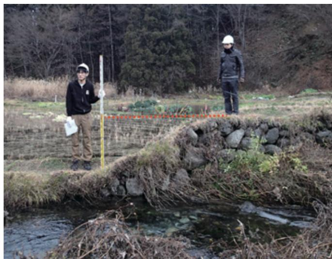
2014年 M6.7 長野県北部の地震直後におこなった地表踏査。地表地震断層による1m弱の段差が出現していた。
