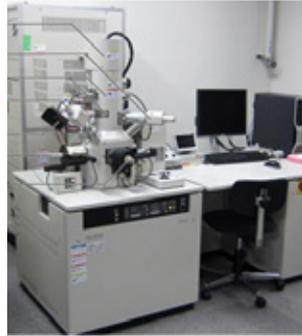
任意の箇所から薄膜 TEM 試料を作製する集束イオンビーム加工装置
