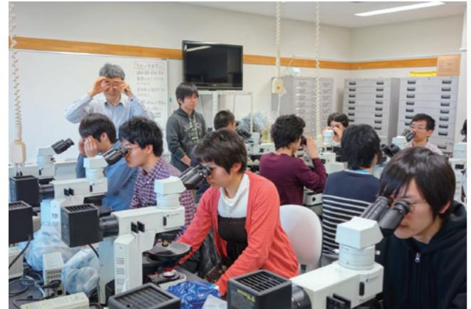
「造岩鉱物光学実習」では、実際の岩石・鉱物試料を手に取りその物理的特徴を捉えたり、偏光顕微鏡を用いて光学的性質を利用した鑑定作業を行います。
