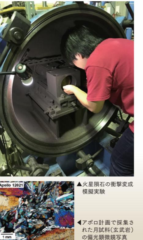
▲火星隕石の衝撃変成模擬実験
