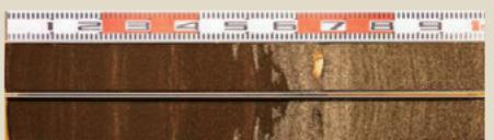
(図2)掘削コアの断面写真。海成砂の中に貝化石が埋没している。
